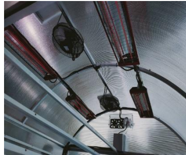
ภาพที่ 5 การอบแห้งพลังงานแสงอาทิตย์แบบไฮบริด โดยฮีตเตอร์ไฟฟ้าพัดลมเสริม
