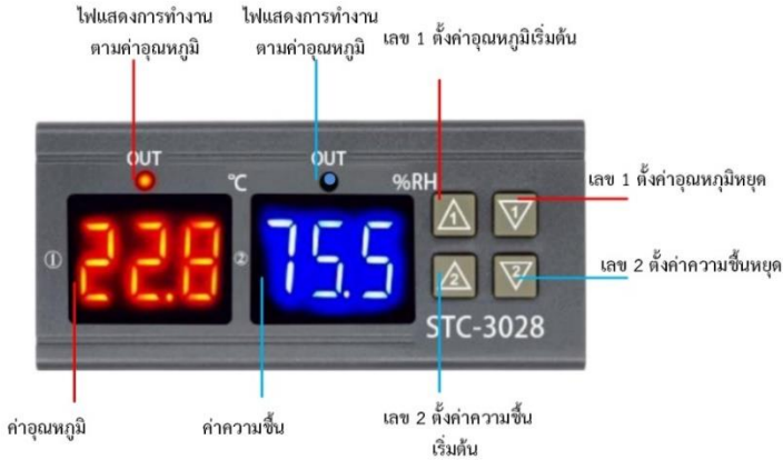
ภาพที่ 26 หน้าจออุปกรณ์ควบคุมอุณหภูมิและความชื้น
