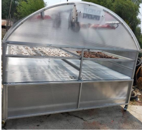
ภาพที่ 12 เครื่องอบแห้งที่ดำเนินการเสร็จแล้ว
