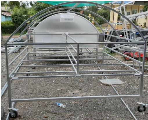
ภาพที่ 7 โครงสร้างเครื่องอบแห้งพาราโบลาโดม
