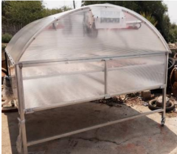
ภาพที่ 5 การอบแห้งพลังงานแสงอาทิตย์แบบไฮบริด โดยฮีตเตอร์ไฟฟ้าพัดลมเสริม
