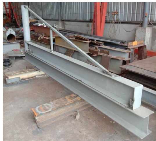
ข. แขนยื่นเครนผ่านการเชื่อมและทำสีรองพื้น
