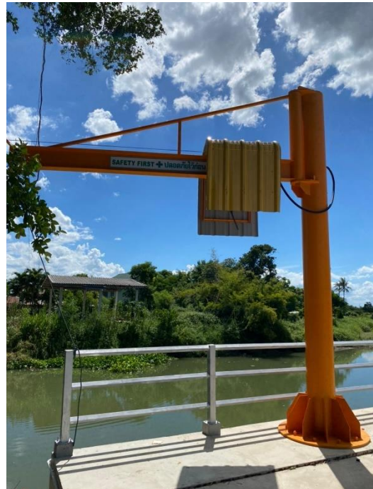
ภาพที่ 33 การติดตั้งเสาครนและแขนยื่น
