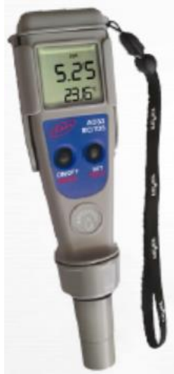
ภาพที่ 2 เครื่องวัดค่าน้ำ (ความเป็นกรด-ด่าง)
